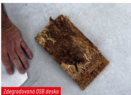
Při měření hmotnostní vlhkosti OSB desky přesáhla hodnota limit měřicího přístroje, který je 50 %
