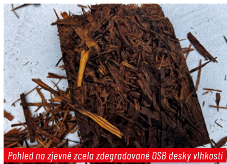
Pohled na vlhkostní poruchu v podstřešní bytové jednotce
